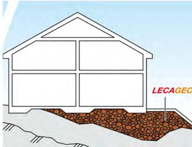
**Bild 10:** Beispiel eines Geländeaufbaus unter der Erweiterungsfläche
